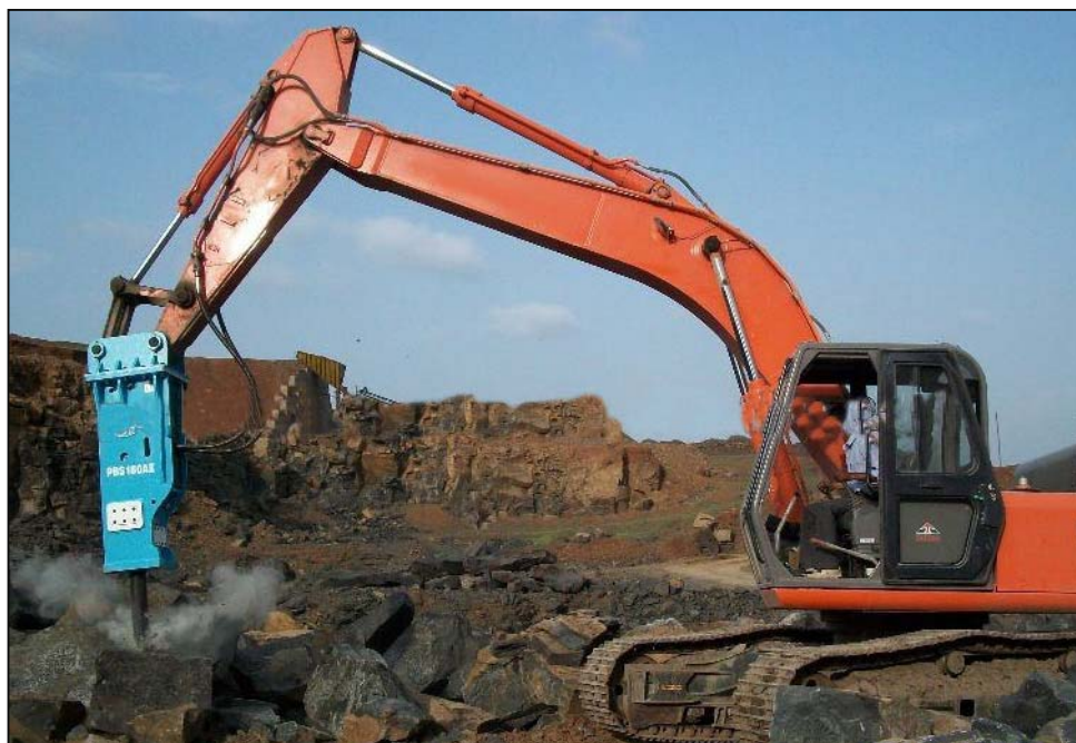
Слика бр. 24 – Уситњавање негабарита механичким ударним чекићем
