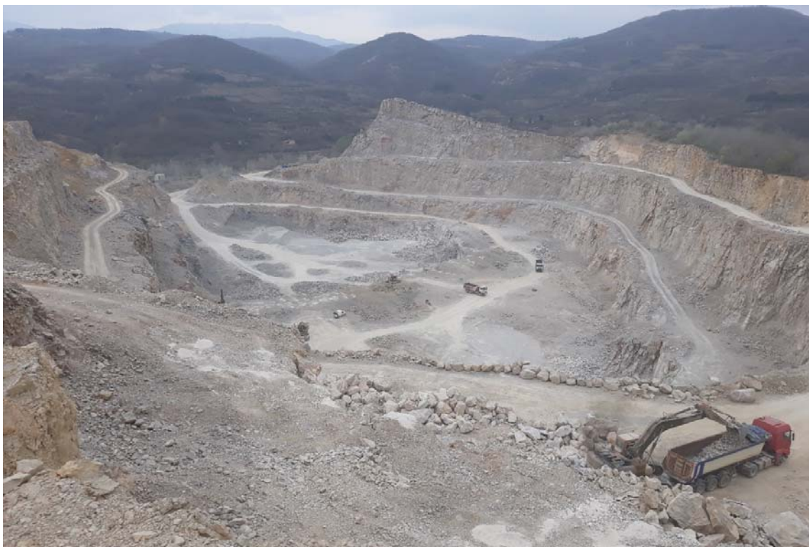
Slika br. 21 – Izgled transportnih puteva na PK Dolac i utovar odminiranog krečnjaka u transportno sredstvo
