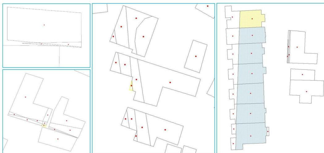
SLIKA 7.4: Primeri tipičnih problema sa geometrijom poligona zgrada
