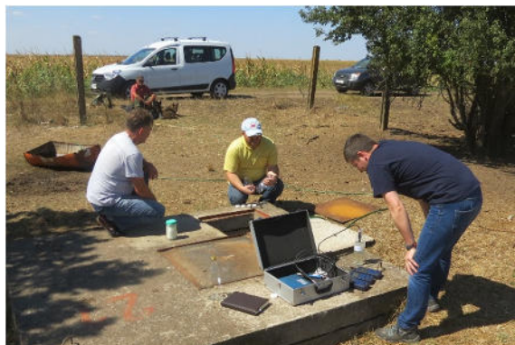
Слике 2 – 5. Узорковање подземне воде и in situ мерење квалитета подземних вода током првог дела теренских истраживања у периоду 25.08.2017. до 1.09.2017. год.
