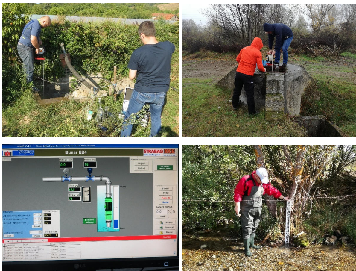
Слика 11-14 Мерења нивоа подземних вода нивомером (горе лево и десно); интерним системом надзора (доле лево); водомерном летвом (доле десно)
