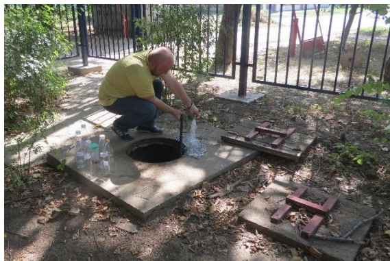
Слике 2 – 5. Узорковање подземне воде и in situ мерење квалитета подземних вода током првог дела теренских истраживања у периоду 25.08.2017. до 1.09.2017. год.
