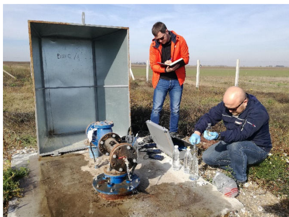
Слике 6 – 9. Узорковање подземне воде и in situ мерење квалитета подземних вода током другог дела теренских истраживања у периоду 01.11.2017. до 09.11.2017. год.
