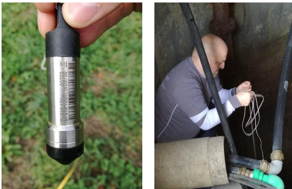
Слика 15. Инсталирање опреме за континуално мерење нивоа подземних вода
