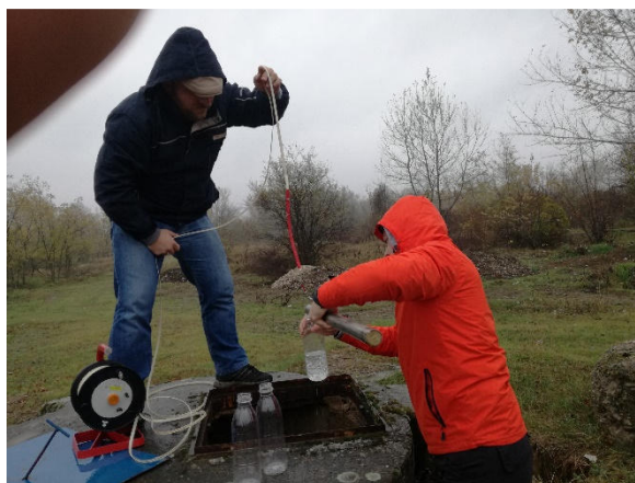
Слике 6 – 9. Узорковање подземне воде и in situ мерење квалитета подземних вода током другог дела теренских истраживања у периоду 01.11.2017. до 09.11.2017. год.
